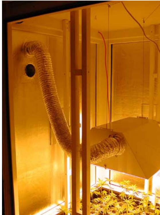
רפלקטור מחובר לצינור אוורור – מה שנקרא Air Cooling Hood
